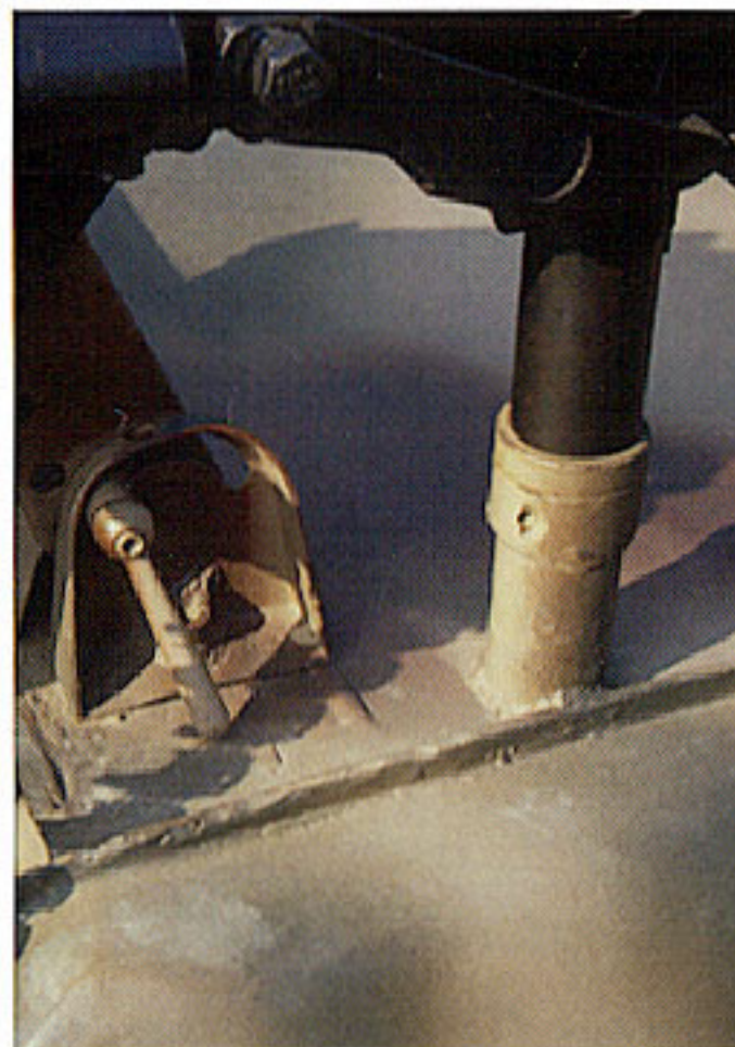
Obrázky zobrazují použití držáků pro uchycení kulometu vpředu a v zadní části vozidla.
