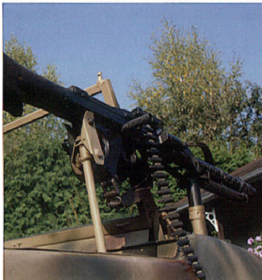
Obrázky zobrazují použití držáků pro uchycení kulometu vpředu a v zadní části vozidla.
